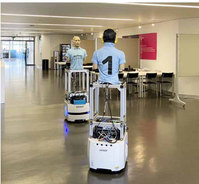
Abb. 2: Akustikmessungen mit den beiden Robotern im Gang F525
