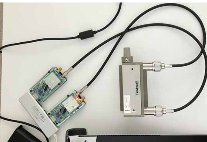
Abb. 2: Der Versuchsaufbau zur Verifikation des Testsenders
