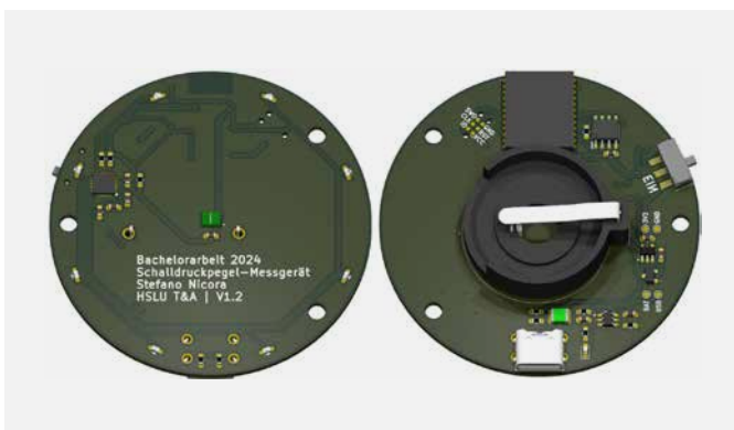
Abb. 3: Finales PCB | Durchmesser: 60mm
