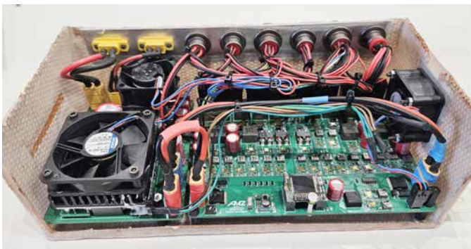
Abb. 4: Boxverkabelung DCDC-PCB und LV-Supply
