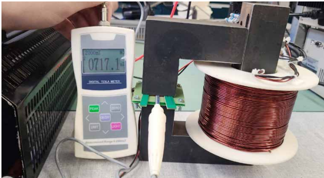
Abb. 1: Magnetischer Kreis zum Sättigen der Kerne und Gauss-Meter
