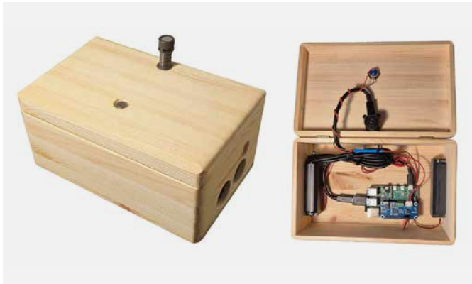
Abb. 1: Aussen- und Innenansicht – Lokaler Sprachassistent
