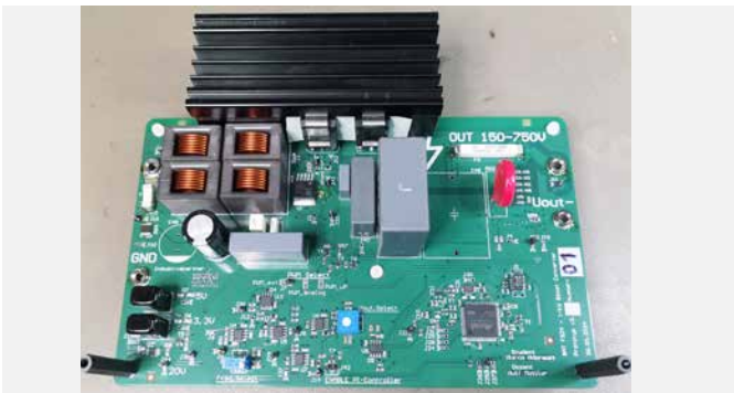
Abb. 2: Prototyp 2 – zusammengebaut und mit Kühlkörper
