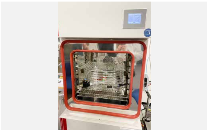
Abb. 2: Aufnahme des Testsystems aufgebaut im Klimaprüfschrank
