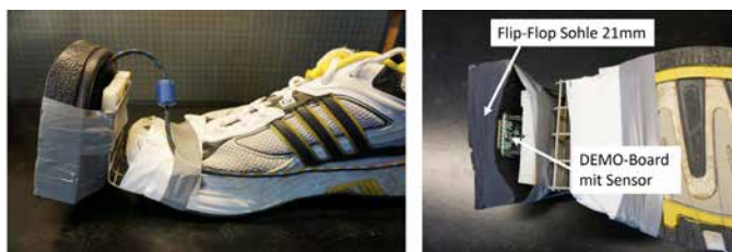
Abb. 2: Prototypen Aufbau für Machbarkeits-Analyse
