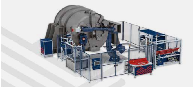
Abb. 1: Anlage zur Automatisierung der Pfannenvorbereitung
