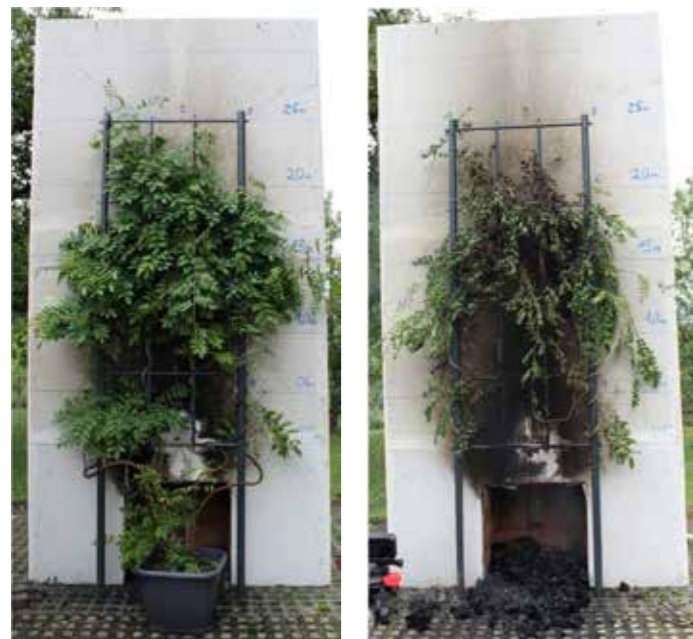
Abb. 27: Brandversuch mit einem troggebundenen System. Pflanzenart: Blauregen (© NODER „Begrünte Fassaden aus brandschutztechnischer Sicht“, 2019)
