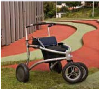
Mit iWalkActive entwickelt das iHomeLab einen intelligenten Rollator mit Elektromotor und Navigationssystem. Er ist daher weit mehr als eine Gehhilfe: Der Rollator hilft älteren Menschen, sich im Alltag zurecht zu finden und leitet zum Beispiel zur nächsten Toilette und versorgt sie über das eingebaute Navigationssystem mit wichtigen Informationen.
